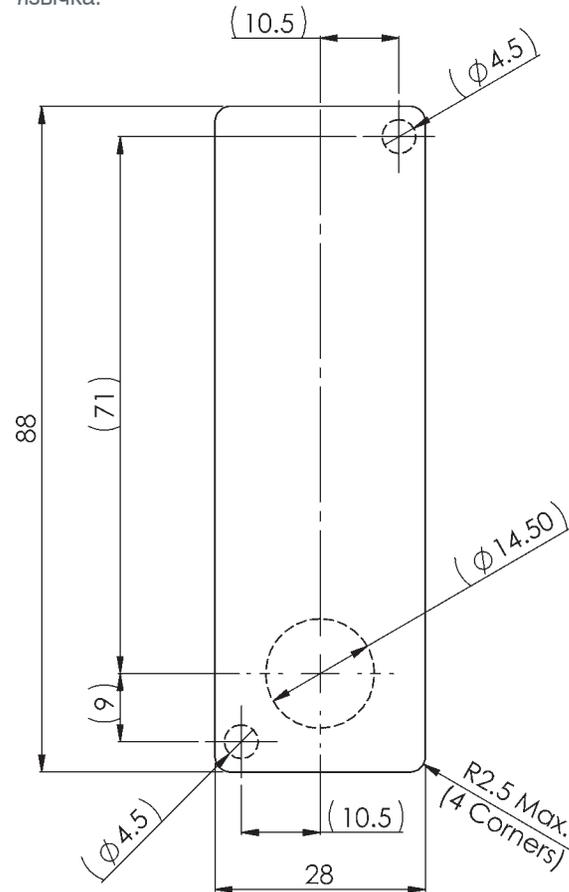
При монтаже замка вровень с панелью используйте прямоугольный контур (88 мм x 28 мм). При монтаже на поверхности панели используйте 3 указанные монтажные отверстия.
